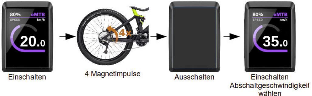
Der Modus zum Einstellen der maximalen **Unterstützungsgeschwindigkeit** ist nun aktiv und der Tacho zeigt die aktuelle Einstellung an (z.B. 35 km/h). Durch Vorbeibewegen des Magneten vor dem Sensor können Sie nun durch alle Einstellmöglichkeiten durchgehen:
