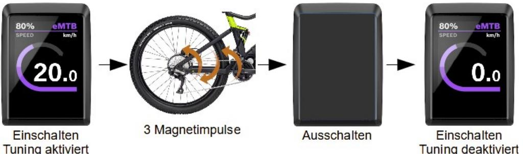
Der Tacho zeigt nach dem Einschalten nun **0 km/h** an, um das deaktivierte Tuning zu signalisieren. Das eBike funktioniert nun wie eines ohne Tuningmodul.
