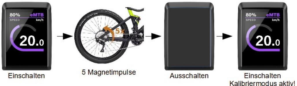
Der **Kalibriermodus** ist nun aktiv und es wird **dauerhaft** eine Geschwindigkeit von ungefähr 20 km/h angezeigt. Durch Bewegen des Magneten vor dem Sensor stellen Sie nun die angezeigte Geschwindigkeit auf **20 km/h** wie folgt ein:
