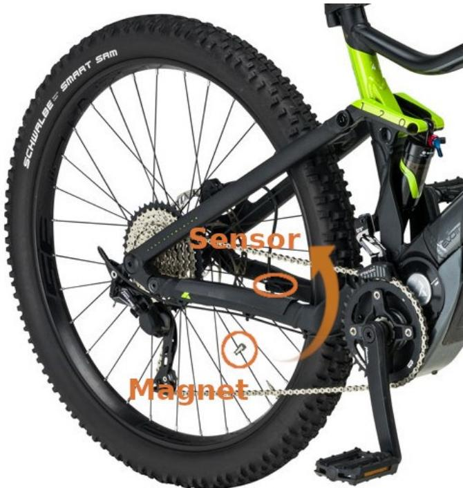
Den Magneten finden Sie an den Speichen Ihres Hinterrades befestigt. Der Geschwindigkeitssensor ist am Rahmen befestigt, sodass ihn der Magnet bei jeder Radumdrehung passiert. Idealerweise kippen Sie das Rad ganz leicht nach links über den Fahrradständer. So können Sie das Hinterrad ganz leicht mit der Hand bewegen.
