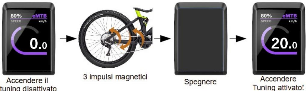
Per segnalare l'attivazione del tuning, il tachimetro visualizzerà **20 km/h** per alcuni secondi dopo l'accensione.
