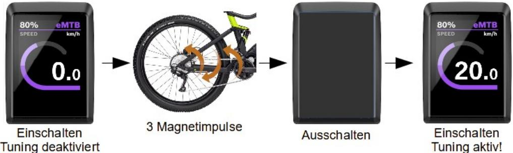
Um das dauerhafte Tuning zu signalisieren, zeigt der Tacho nach dem Einschalten nun für ein paar Sekunden **20 km/h** an.
