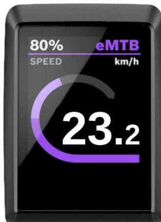
A partire da una velocità regolabile (impostazione di fabbrica fino a 35 km/h) il supporto motore viene disattivato.
