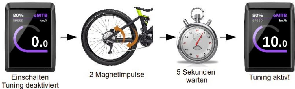
Nach Ablauf der 5 Sekunden zeigt der Tacho eine Geschwindigkeit von **10 km/h** an, um das aktive Tuning zu signalisieren.
