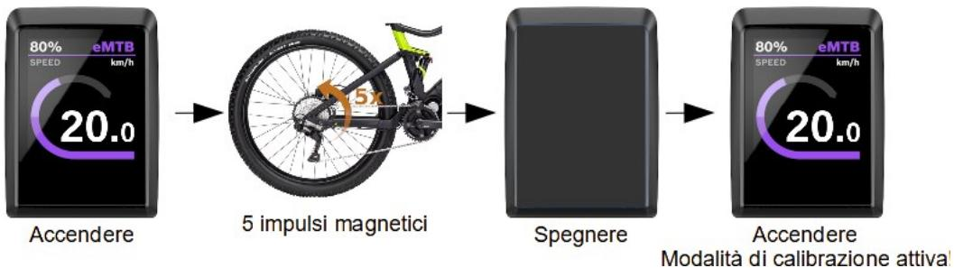
La modalità di **calibrazione** è ora attiva, ciò significa che visualizzerà **permanentemente** una velocità di circa 20 km/h.
