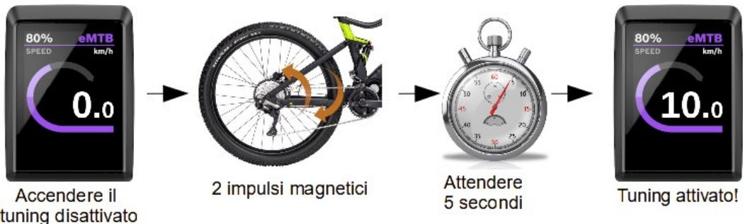
Trascorsi i 5 secondi, il tachimetro visualizza una velocità di **10 km/h** per segnalare il tuning attivo.
