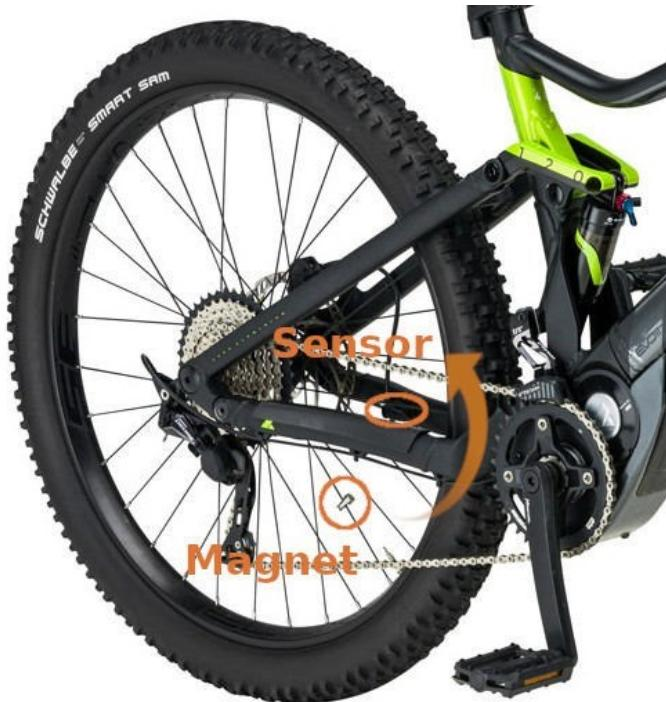
Il magnete è attaccato ai raggi della ruota posteriore. Il sensore di velocità è fissato al telaio in modo che il magnete lo superi a ogni rotazione della ruota. L'ideale è inclinare
